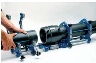
Вставляем полиэтиленовую трубу до центрального ограничителя или до маркировки. Закрепляем зажим для монтажа. Вставляем вторую полиэтиленовую трубу до центрального ограничителя или до маркировки, закрепляем зажим для монтажа.
