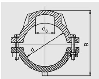
Компактное изделие из двух ПЭ-ВП седловин для ремонта небольших повреждений труб **с и без** выхода транспортируемой среды. Для предотвращения попадания транспортируемой среды в зону сварки, поврежденное место глушится дополнительной пробкой\* ( $\leq d_3$ ). С открытым нагревательным элементом для оптимальной теплопередачи. \*Пробка не поставляется.
