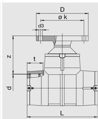
Компактное изделие из ПЭ-ВП. Заводское исполнение комбинации FRIALEN - тройника, перехода и вваренного буртика (жесткий фланец). Тройник с открытым нагревательным элементом для оптимальной теплопередачи, имеет большую глубину сопряжения, особо широкую зону сварки, а также холодную зону на торце и в центре, предотвращающую вытекание расплавленной массы, не требует при работе специальных держателей и приспособлений. На сварном шве перехода не образуется наплыва.
