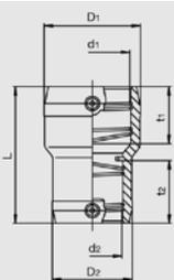
Имеют открытую нагревательную спираль для оптимальной теплопередачи, большую глубину сопряжения, особо широкую зону сварки, холодные зоны по бокам и в центре, предотвращающие вытекание расплавленной массы, не требуют при работе специальных позиционеров и приспособлений.
