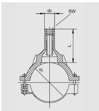
Компактное изделие седловой формы из ПЭ-ВП с открытым нагревательным элементом для оптимальной теплопередачи и выходным патрубком для FRIALEN - муфт типа MB или UB. Врезка без стружки в безнапорном состоянии при помощи интегрированной фрезы.
