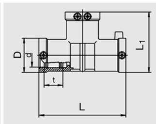
Имеют открытую нагревательную спираль для оптимальной теплопередачи на всех 3 выходах, большую глубину сопряжения, особо широкую зону сварки, холодные зоны по бокам и в центре, предотвращающие вытекание расплавленной массы, не требуют при работе специальных позиционеров и приспособлений. Прямоточная сторона сваривается за одну установку сварочного аппарата, вследствие этого необходимы только 2 сварки.
