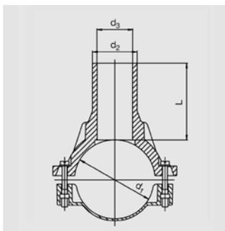
Компактное изделие из ПЭ-ВП седловины с открытым нагревательным элементом для оптимальной теплопередачи и выходным патрубком для монтажа вместе с FRIALEN - муфтами типа MB или UB. Врезка выполняется в безнапорном состоянии с помощью подходящего приспособления для врезки. Мы рекомендуем Huetz & Baumgarten ([www.huetz-baumgarten.de](http://www.huetz-baumgarten.de)).
