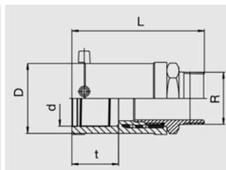
Компактное изделие. Часть ПЭ-ВП имеет открытый нагревательный элемент для оптимальной теплопередачи, большую глубину сопряжения, особо широкую зону сварки, а также холодную зону, предотвращающую вытекание расплавленной массы на торце и в области перехода, для сварки без позиционеров. Стальная часть неразъемная и надежно закреплена от прокручивания в ПЭ-ВП. Самоуплотняющаяся запатентованная геометрия уплотнения **без эластомерного уплотнения.** Для применения в области газоснабжения.
