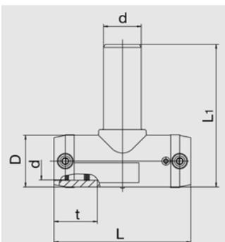
Прямой проход имеет открытую нагревательную спираль для оптимальной теплоотдачи, большую глубину сопряжения, особо широкую зону сварки, а также предотвращающие вытекание расплавленной массы холодные зоны сварки на торцах и в середине для сварки без позиционеров. Удлиненный отводной патрубок рассчитан на 2 сварки.
