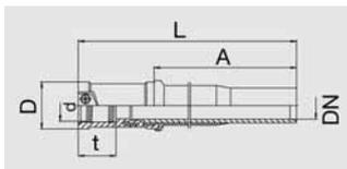
Компактное изделие. Часть ПЭ-ВП имеет открытую нагревательную спираль для оптимальной теплопередачи, большую глубину сопряжения, особо широкую зону сварки, а также холодную зону, предотвращающую вытекание расплавленной массы, на торце и в области перехода, не требует использования позиционеров. Стальная часть неразъемная и надежно закреплена от прокручивания в ПЭ-ВП. Самоуплотняющаяся запатентованная геометрия уплотнения **без эластомерного уплотнения**. Для применения в области газоснабжения.
