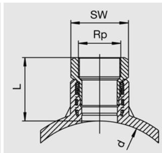
Применяется для адаптации ко **всем** диаметрам труб в заданной области с помощью прижимного приспособления FRIALEN FRIATOP (см. прайс-лист на приборы и технику FRIATOOLS). Компактное изделие. Представляет собой седловину из ПЭ-ВП с открытым нагревательным элементом для оптимальной теплопередачи. Переход ПЭ-ВП/красное литье является неразъемным и надежно застопорен в ПЭ-ВП от проворачивания. Служит для присоединения обычных латунных вентилях.
