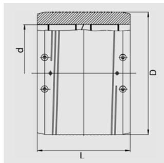
Имеет открытую нагревательную спираль для оптимальной теплопередачи, большую глубину сопряжения, широкую зону сварки, холодные зоны по бокам и в центре, предотвращающие вытекание расплавленной массы, не требуют при работе специальных держателей и приспособлений. Начиная с d 180 имеют жидкостные индикаторы для визуального контроля процесса сварки. Сварка труб SDR 11 - SDR 7,4. **Начиная с d280 - с технологией предварительного прогрева для оптимального перекрытия зазоров (по необходимости)..**
