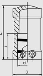
Имеет открытую нагревательную спираль для оптимальной теплопередачи, большую глубину сопряжения, особо широкую зону сварки, холодную зону на торце, предотвращающую вытекание расплавленной массы. Начиная с d 180 имеют жидкостные индикаторы для визуального контроля процесса сварки.
