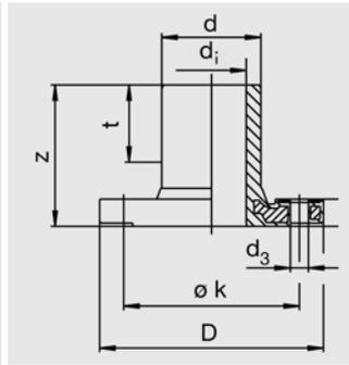
Ввариваемый буртик и фланец представляют собой цельное фланцевое изделие. Металлическая вставка во фланце для предотвращения явлений холодной текучести. Привариваемая часть пригодна для работы с FRIALEN - муфтами типа MB и UB. Размеры фланца согласно DIN 2501, часть 1. Рекомендуются уплотнения GST.
