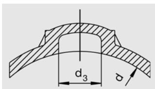
Для адаптации к трубам всех диаметров указанного диапазона с помощью прижимного приспособления FRIALEN FRIATOP (см. прайс-лист на приборы и технику FRIATOOLS). ПЭ-ВП седловина для ремонта небольших повреждений труб **с и без** выхода среды. Для предотвращения выхода среды должна применяться отдельная пробка\* ( $\leq d_3$ ). С открытым нагревательным элементом для оптимальной теплопередачи.
