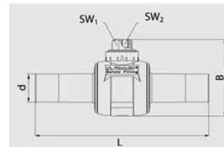
Компактное изделие из ПЭ-ВП, привариваемое в процессе монтажа FRIALEN - муфтами MB или UB. Проход крана соответствует внутреннему диаметру трубы. Не требуется мероприятий по защите от коррозии. Открытое и закрытое положения определяются упорами. Запорный кран, не требующий технического обслуживания, управляется с помощью штанги (например FRIALEN - BS).
