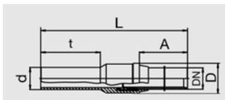
Компактное изделие. Часть ПЭ-ВП для приваривания FRI-ALEN - муфт типа MB и UB без специальных позиционеров и приспособлений. Стальная часть неразъемная и надежно закреплена от прокручивания в ПЭ-ВП. Самоуплотняющаяся запатентованная геометрия уплотнения **без эластомерного уплотнения**. Небольшой расход изоляции благодаря установленному защитному патрубку.
