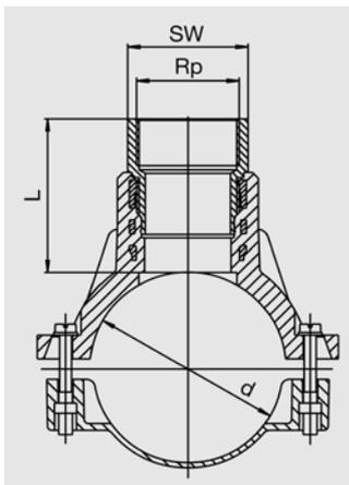
Компактное изделие. Представляет собой седловину из ПЭ-ВП с открытым нагревательным элементом для оптимальной теплопередачи. Переход ПЭ-ВП/красное литье является неразъемным и надежно застопорен в ПЭ-ВП от проворачивания. Служит для присоединения обычных латунных вентиляй.
