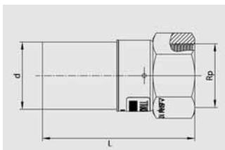
Компактное изделие. Полиэтиленовая часть дает возможность производить монтаж вне зависимости от положения и обеспечивает герметичное сварное соединение со всеми подходящими фасонными изделиями FRIALEN. Латунная часть неразъемна и надежно без возможности проворачивания соединена с полиэтиленовой.
