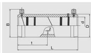
Муфты надежность-ПЛЮС, имеющие много плюсов в отношении безопасности. Имеют открытую нагревательную спираль для оптимальной теплопередачи, особо большую глубину сопряжения, особо широкую зону сварки, особо большие холодные зоны по бокам и в центре, обеспечивают оптимальное сопряжение с трубами с изогнутыми концами (из бухт), не требуют при работе специальных позиционеров и приспособлений.
