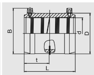
Применяются также как ремонтные муфты. Имеют открытую нагревательную спираль для оптимальной теплопередачи, большую глубину сопряжения, особо широкую зону сварки, холодные зоны по бокам и в центре, предотвращающие вытекание расплавленной массы, не требуют при работе специальных позиционеров и приспособлений.
