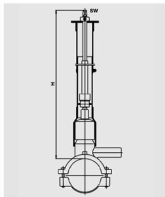
Телескопическая приводная штанга для управления вентилем FRIALEN - DAV с уличного люка. В заданном диапазоне (Н) бесступенчато регулируется без инструментов, что также возможно в смонтированном состоянии. Самостопорится в любом положении. Защищена от коррозии.
