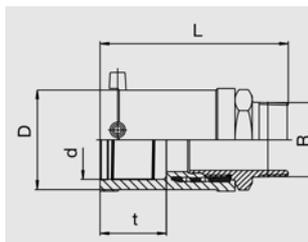
Компактное изделие. Часть ПЭ-ВП имеет открытый нагревательный элемент для оптимальной теплопередачи, большую глубину сопряжения, особо широкую зону сварки, а также холодную зону, предотвращающую вытекание расплавленной массы на торце и в области перехода, для сварки без позиционеров. Латунная часть неразъемная и надежно закреплена от прокручивания в ПЭ-ВП. Самоуплотняющаяся запатентованная геометрия уплотнения **без эластомерного уплотнения**. Для применения в области водоснабжения.
