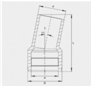
Для универсального и свободного от внутренних напряжений корректирования направления трубопровода, в т.ч. и в стесненных условиях. Достигается максимальная универсальность благодаря вариантам монтажа. Путем комбинации возможно создание отводов 22°, 33° и т.д. Муфтовая часть имеет открытую нагревательную спираль для оптимальной теплопередачи, большую глубину сопряжения, особо широкую зону сварки. Спиготная часть подходит для сварки с помощью муфт FRIALEN MB или UB.
