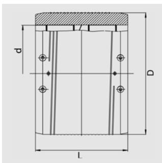
Имеет открытую нагревательную спираль для оптимальной теплопередачи, большую глубину сопряжения, особо широкую зону сварки, холодные зоны по бокам и в центре, предотвращающие вытекание расплавленной массы, не требуют при работе специальных держателей и приспособлений. Начиная с d 250 имеют цветочные жидкостные индикаторы для визуального контроля процесса сварки.
