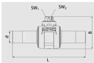
Компактное изделие из ПЭ-ВП, привариваемое в процессе монтажа FRIALEN - муфтами MB или UB. Не требуется мероприятий по защите от коррозии. Открытое и закрытое положения определяются упорами. Запорный кран, не требующий технического обслуживания, управляется с помощью штанги (например FRIALEN - BS).
