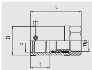
Компактное изделие. Часть ПЭ-ВП имеет открытый нагревательный элемент для оптимальной теплопередачи, большую глубину сопряжения, особо широкую зону сварки, а также холодную зону, предотвращающую вытекание расплавленной массы на торце и в области перехода, для сварки без позиционеров. Часть красного литья неразъемная и надежно закреплена от прокручивания в ПЭ-ВП. Самоуплотняющаяся запатентованная геометрия уплотнения **без эластомерного уплотнения**. Для применения в области водоснабжения.
