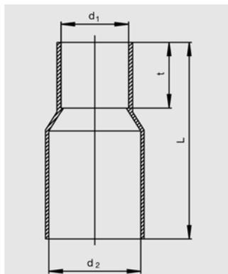
Насаживается на приводной 4-х гранник FRIALEN - DAV для перехода на стандартную штангу с защитной трубой 50 мм.
