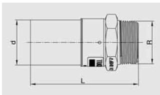
Компактное изделие. Полиэтиленовая часть дает возможность производить монтаж вне зависимости от положения и обеспечивает герметичное сварное соединение со всеми подходящими фасонными изделиями FRIALEN. Латунная часть неразъемна и надежно без возможности проворачивания соединена с полиэтиленовой.
