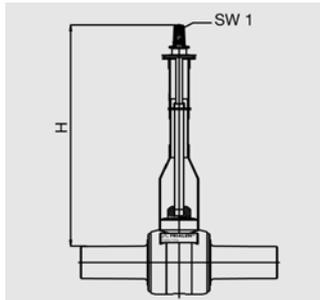
Телескопическая приводная штанга для управления кранами FRIALEN - КН, КНР, АКНР и АКНР-TL через ковер. В заданной области (H) бесступенчатая установка по высоте, также в смонтированном состоянии. Самофиксирующийся при любом положении вытяжения. Устойчив к коррозии. **Исполнение с ключом 14 – специально для домовых вводов.**
