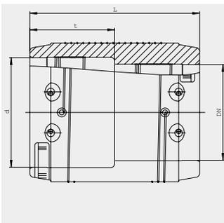
Предназначены для перехода со стандартной трубы на трубу для релайнинга. Имеют открытую нагревательную спираль для оптимальной теплопередачи, большую глубину сопряжения, особо широкую зону сварки, холодные зоны по бокам и в центре. С отдельными сварными зонами. Уменьшение зазора между трубой и муфтой при монтаже возможно при применении технологии предварительного прогрева. См. руководство по монтажу для муфт для релайнинга. **С технологией предварительного прогрева.**
