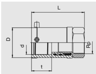
Компактное изделие. Часть ПЭ-ВП имеет открытый нагревательный элемент для оптимальной теплопередачи, большую глубину сопряжения, особо широкую зону сварки, а также холодную зону, предотвращающую вытекание расплавленной массы на торце и в области перехода, для сварки без позиционеров. Стальная часть неразъемная и надежно закреплена от прокручивания в ПЭ-ВП. Самоуплотняющаяся запатентованная геометрия уплотнения **без эластомерного уплотнения**. Для применения в области газоснабжения.
