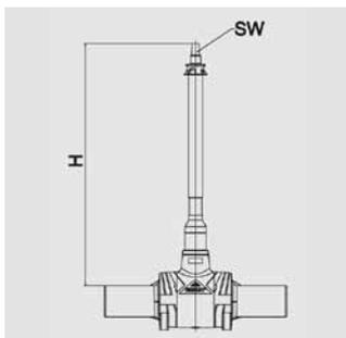
Телескопическая приводная штанга для управления FRIALOC – запорной арматуры из ПЭ для использования с ковером. Оптимально подогнаны друг к другу. В заданной области (H) бесступенчатая установка по высоте. Простой монтаж посредством применения фиксирующей защелки. Исполнение- из оцинкованной или нержавеющей стали.
